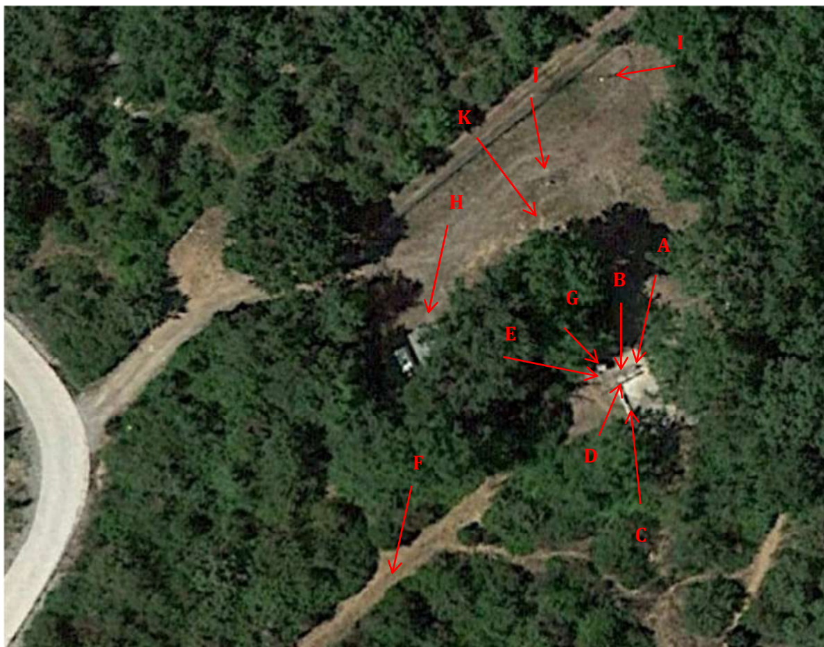
Fig.9 - Fotoaerea anno 2019, estratta da GoogleEarth. A - Pozzo Tassinaie 1, B - Trasduttore contatore volumetrico 1, C- Pozzo Tassinaie 2, D -Contatore volumetrico 2, E - inizio tubo di adduzione in esterno, F . Tubazione interrata, G - Casotto con contatore 1, H - casotto con Plc gestione impianto, I - Stazione meteo, J - Piezometro profondo BV1, K - pozzo abbandonato.
